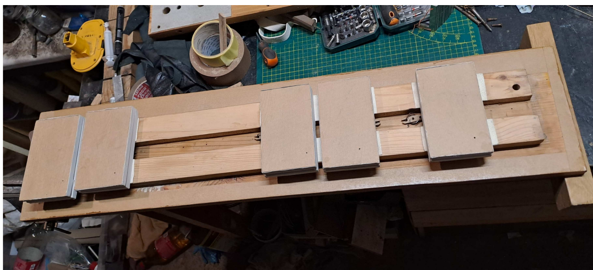
Klinowe mieszki głosowe po renowacji.
