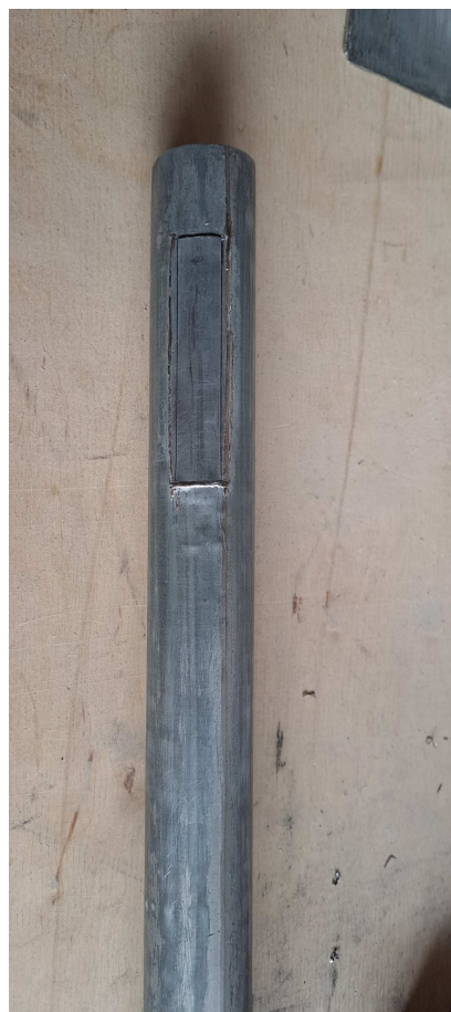
Piszczałka po wymianie dostroika
