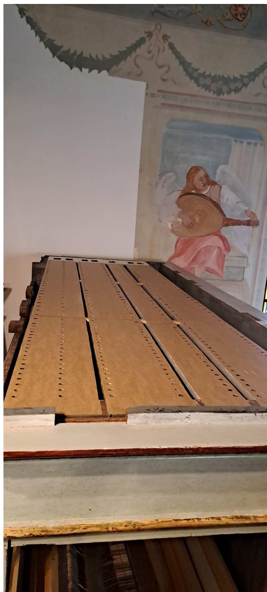
Wiatrownice w trakcie montażu w szafach organowych.
